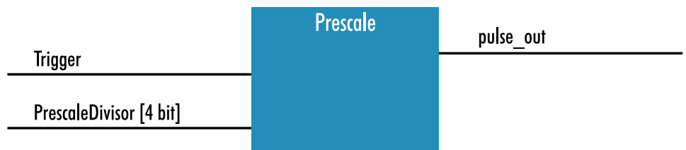
Fig. 5-50: The prescale module
